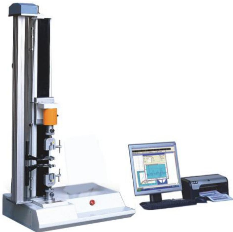
دستگاه تست کشش با ساختار تک ستونه با کنترلر
